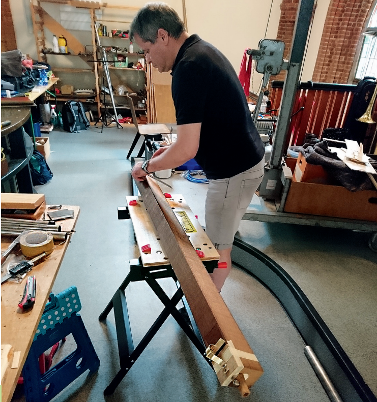
Arbeiten an der neuen Gambe 8'
